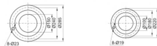
吸入法兰(Suction Flange)DN1 及吐出锥管出口法兰 吐出法兰(Discharge Flange)DN2
